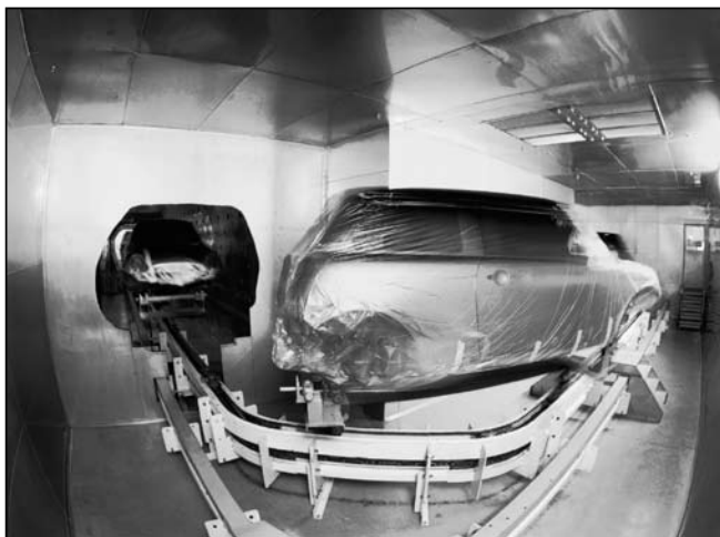
Vorbereitung zur Dachlackierung (Kontrastdach)
