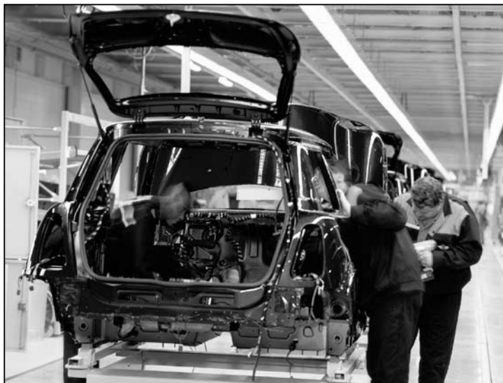
Neuer Mini Produktion Karosseriemontage
