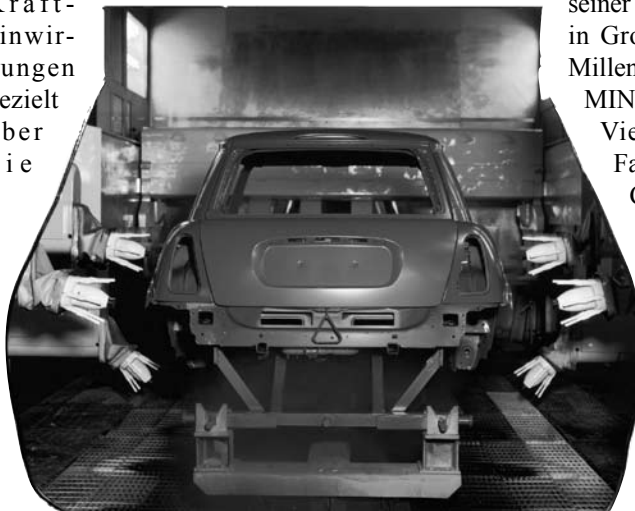
Basislack Applikation (Elektrostatisch)
