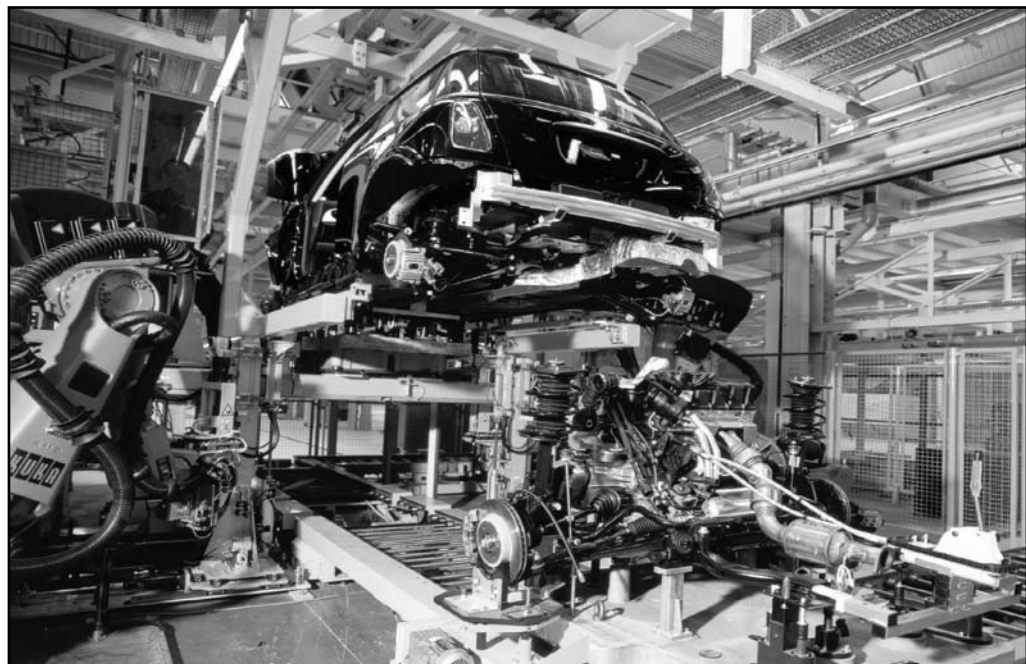
Vollautomatischer einbau des Antriebsagregates
