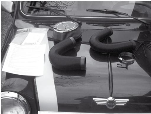
Beinhaltete Teile: Chrom Luftfilter, Schlauchbinder, 2x Luftschlauch, 4x Kabelbinder, Gasseilhalterung
